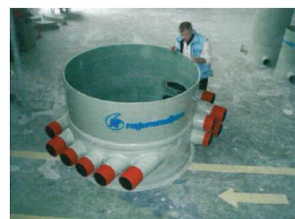
Šaht za Elektroprivredu, 12 PE priključnih cijevi
