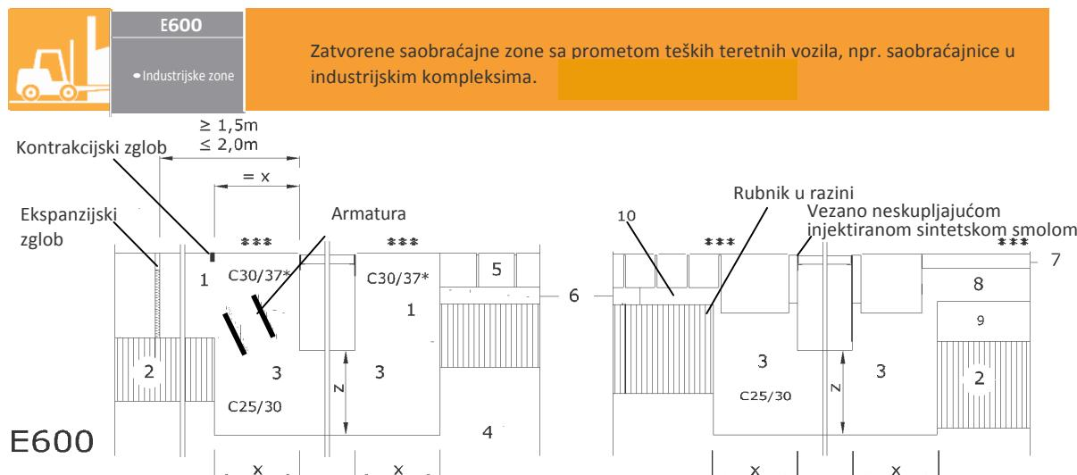
Podloga otporna na slijeganje i mraz se postavlja u skladu sa njemačkim RStO priručnikom za popločavanje puteva za različite klase saobraćajnog opterećenja.
